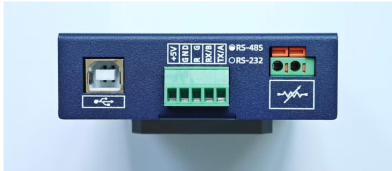
上图：外壳接线端子（以记号标记区分 RS-485/232 版本，图中为 RS-485 版本）
