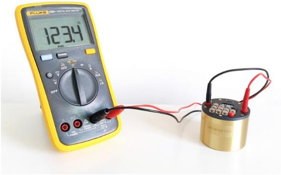
QR-100/101 作为一款数控袖珍可编程电阻箱，以其精湛的设计致力成为技术人员、工程师以及学生等相关电子爱好者得心应手、不可或缺的工具设备。该系列提供高达 8.4 MΩ 的“真”电阻，低至 0.1 Ω 的步进以及 1 mΩ（或 6 位）的分辨率。
